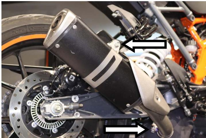
**IT** · Allentare la fascetta, svitare la vite di fissaggio e rimuovere il terminale
