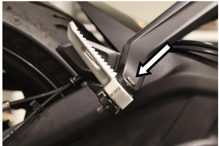
**IT** · Togliere la coppiglia, sfilare il perno originale e sostituirlo con quello fornito
