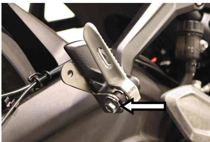
**IT** · Fissare la staffa di sostegno terminale al perno come mostrato in foto
