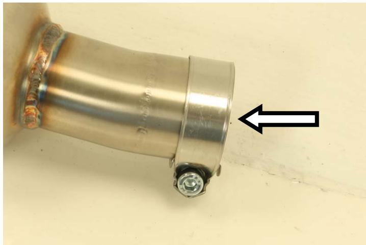
**IT** · Alloggiare la fascetta fornita nel kit di montaggio nell'innesto del terminale
