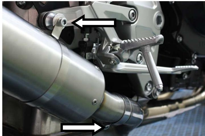
**IT** · Innestare il terminale GP2, fissarlo mediante fascetta interponendo col telaio lo spessore fornito e serrare la fascetta su innesto
