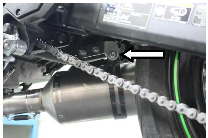
**IT** · Innestare il terminale Race Tech, ancorare la molla e serrarlo alla staffa mediante fascetta di sostegno
