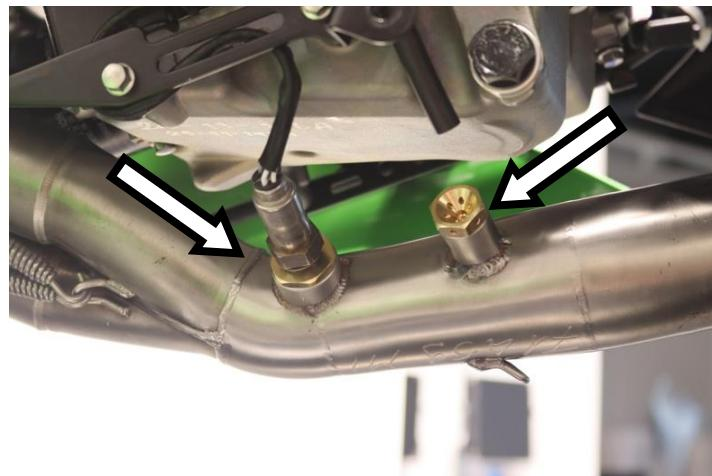
**IT** · Avvitare la sonda lambda nell'attacco del raggruppamento (versioni Euro5) e montare il tappo in ottone come mostrato in foto
