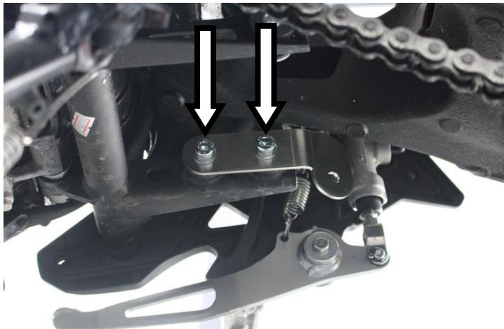
**IT** · Avvitare al telaio la staffa di sostegno terminale come mostrato in foto
