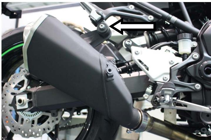
**IT** · Innestare il terminale comprensivo di guarnizione e serrare l'attacco
