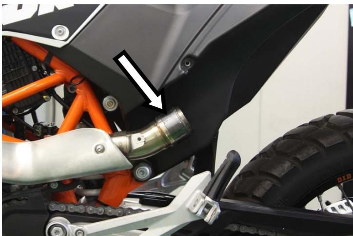
Verificare che la guarnizione originale sia correttamente posizionata nel collettore
