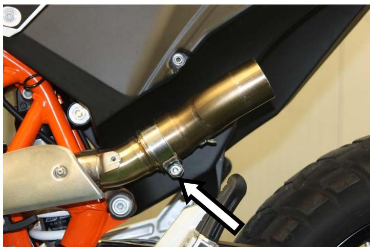
Innestare il raccordo comprensivo di fascetta di serraggio nel collettore
