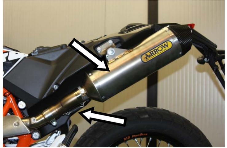
Innestare il terminale, fissare l'attacco alla staffa di sostegno ed ancorare la molla
