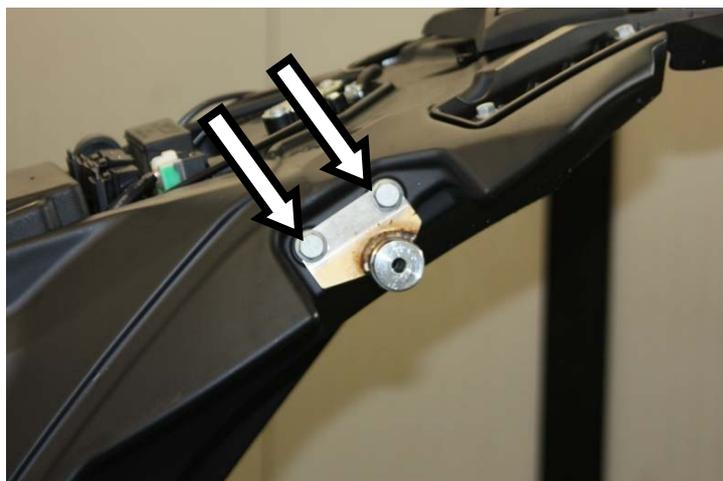
Inserire nel silent block i due spessori e fissare al telaio la staffa di sostegno (operazione necessaria solo se la moto ne e' sprovvista)
