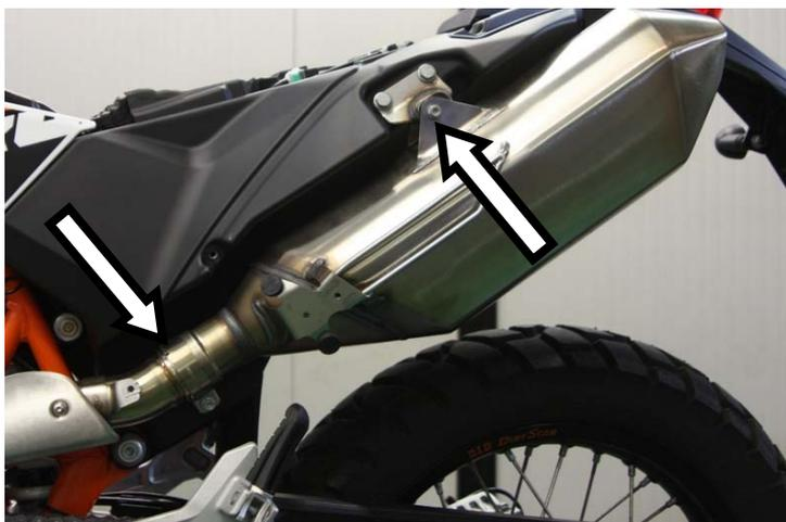
Allentare la fascetta, svitare la vite di fissaggio e rimuovere il terminale originale
