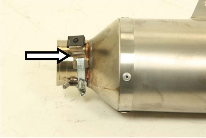
Serrare la fascetta metallica a vite comprensiva di gabbietta e clip M5 nell'innesto del terminale
